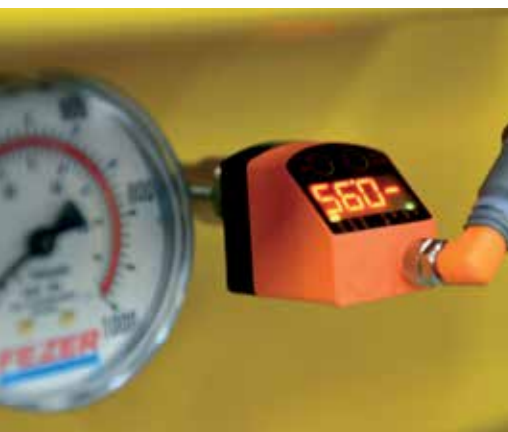
Vakuumgesteuerte Motorschaltung zur Energieeinsparung und Lärmreduzierung
