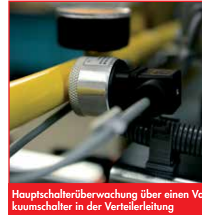
Akustische Warneinrichtung warnt vor Vakuumabfall und Stromausfall
