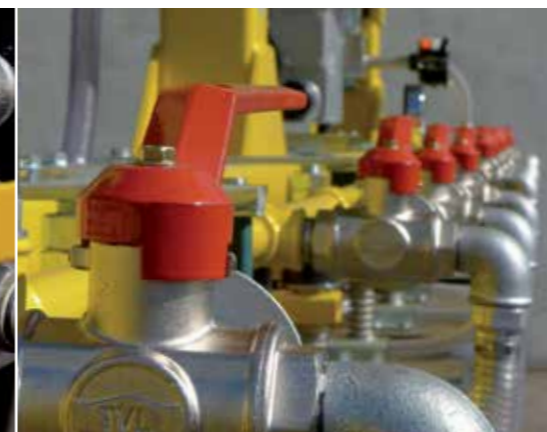
Absperrhähne zum Zu- bzw. Abschalten einzelner Sauggreifer
