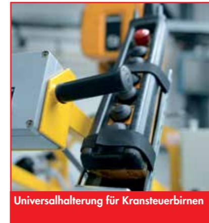
Direktsteuerung für Kranbewegungen über Drucktaster im Manipuliergriff
