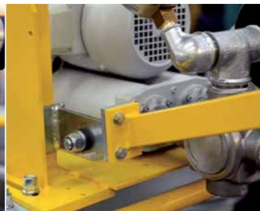
Schwenkmodul für Neigungsanpassung des Manipuliergriffs
