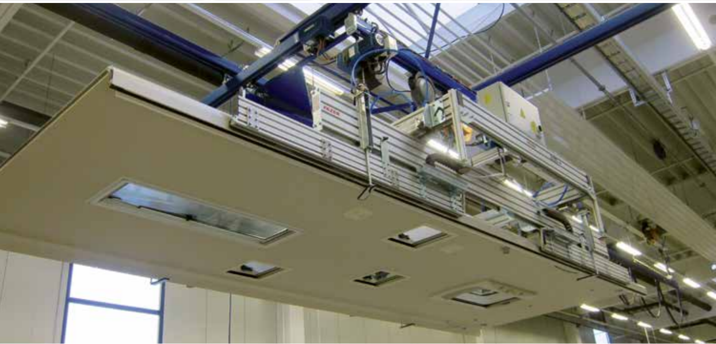
Sondertraverse zum seitlichen Ansaugen von Wohnmobildächern mit pneumatischer Verstellung und mechanischen Untergreifsicherungen
