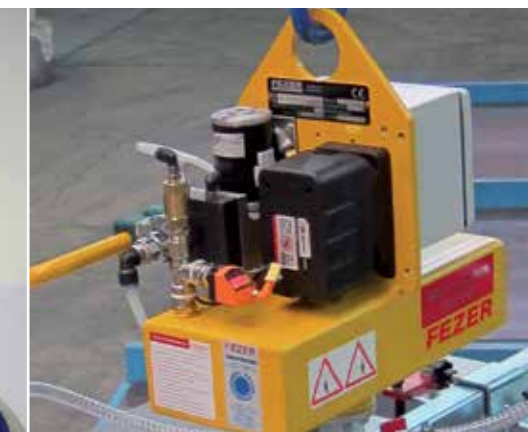
Akku-Modul: Netzunabhängiger Betrieb über 24V-Vakuumgenerator und Wechselakkus
