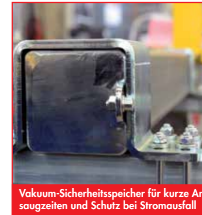
Das Rückschlagventil verhindert ein Belüften über die Pumpe bei Stromausfall
