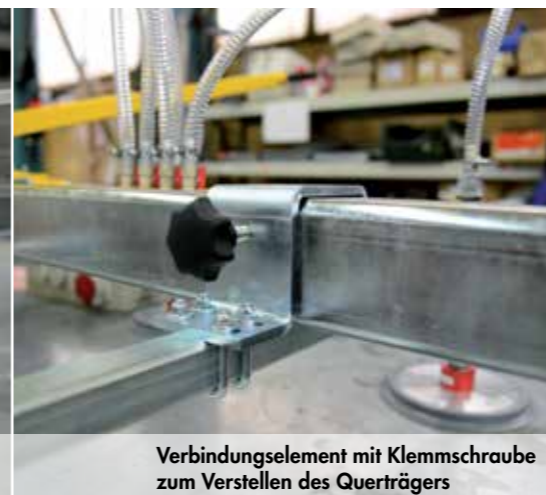
Sauggreifer mit Kreuzklemmstück zum Verstellen auf Querträger
