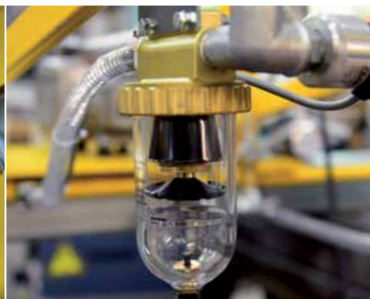
Wasserabscheider mit manuellem Ablass für Einsatz im Freien oder an Wasserstrahlanlagen
