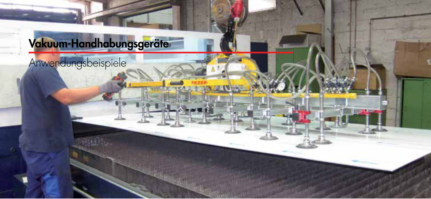
VacuBoy zum Beschicken einer Laserschneidanlage mit Stahlblechen
