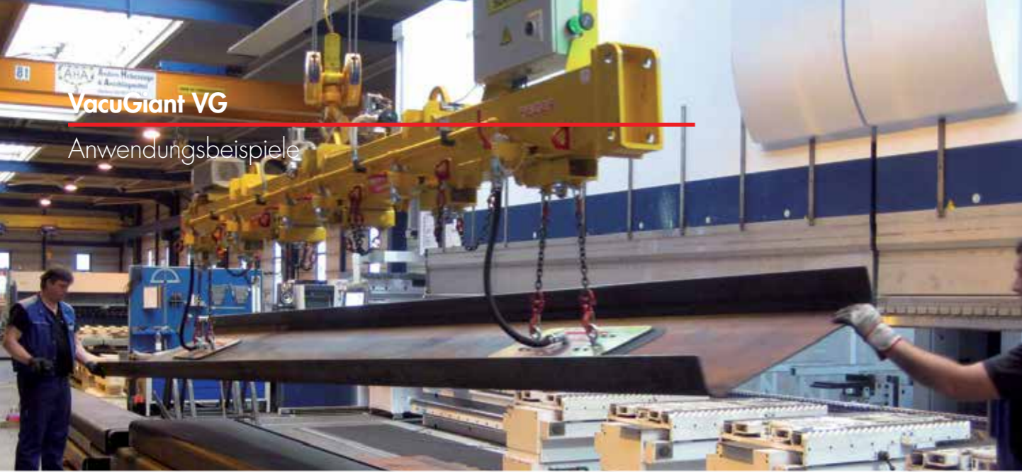
VacuGiant an einer Kantpresse mit Kettenaufhängung und 90° drehbaren Sauggreifern
