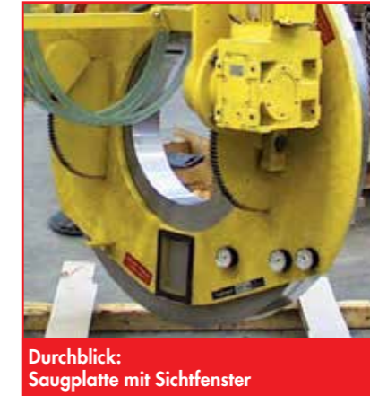
Abgeflachte Saugplatte zur Aufnahme stehender Coils mit unterschiedlichem Durchmesser
